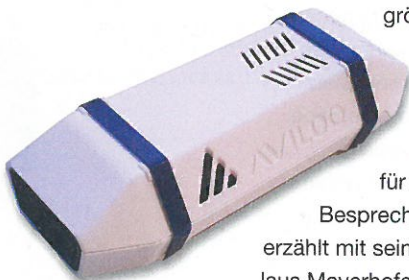
Dieses Gerät überträgt die Daten aus der Batterie an den Aviloo-Server
