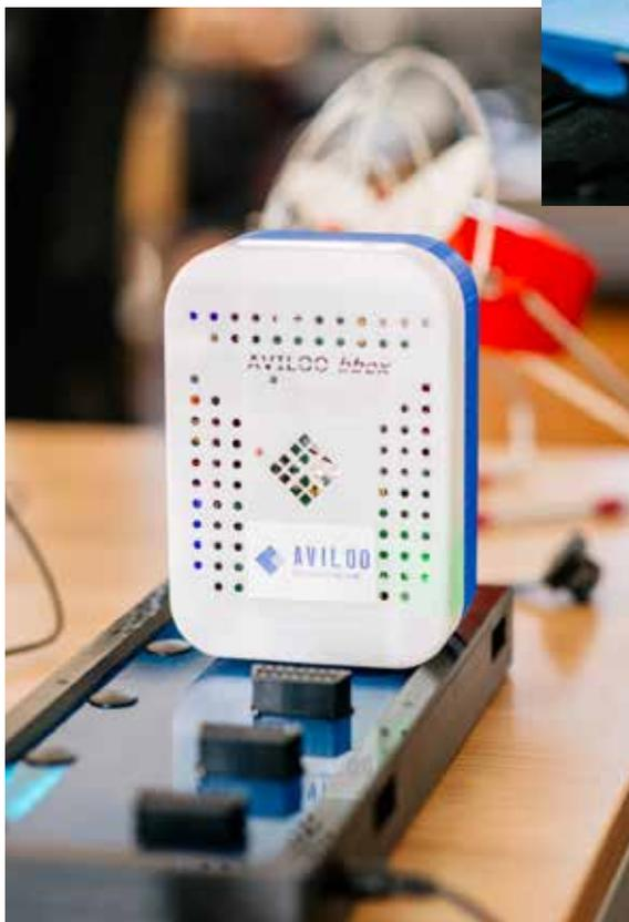
Die „B-Box“ ist das Herzstück des „Battery Health Checks“ und übermittelt während der Testfahrt laufend Batteriedaten.
